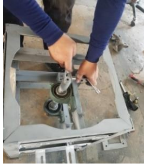
ภาพที่ 11 การประกอบตั้บลูกปืนวายนและเพลาชุดจานใบมีด
