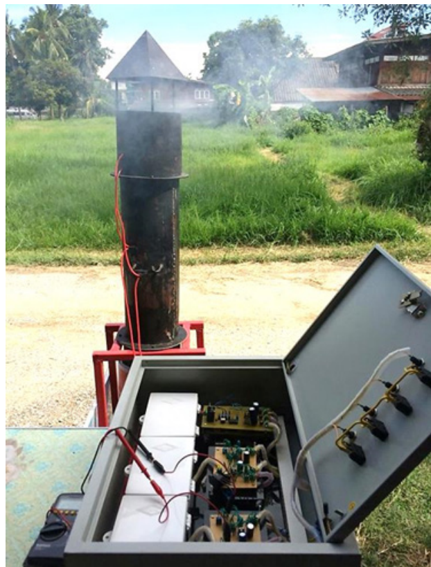
แหล่งจ่ายไฟฟ้าแรงดันสูงและ เครื่องดักจับควอนโรบบ่มไบยาสูบ
