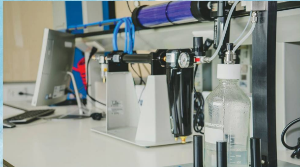
รูปที่ 3 เครื่องมือทดสอบหน้ากากให้ห้องปฏิบัติการ RUEE
